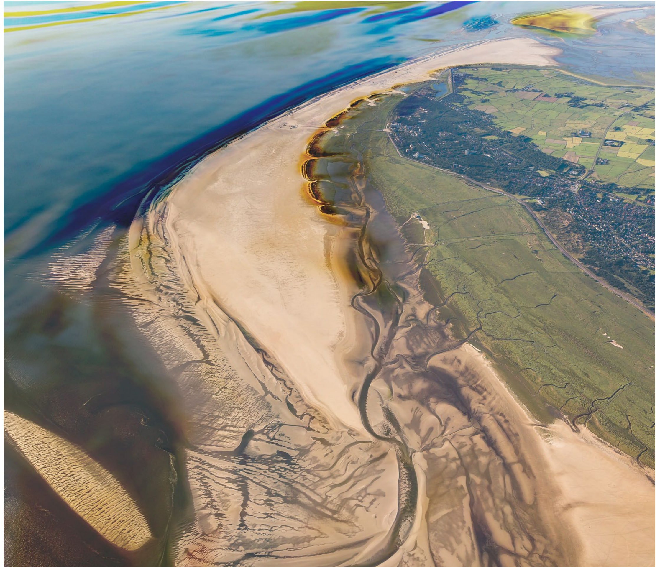
Stranddynamik St. Peter-Ording: Rückgang im zentralen Bereich, Anlagerung im Norden und Süden (Strandrückgang: blau; Anlagerung von Sedimenten: gelb)
