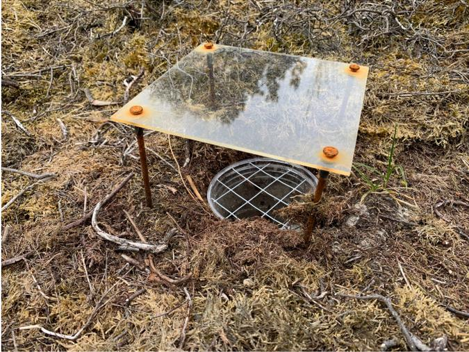
Abb. 2.1 Bodenfalle mit Gitter und Dach. (Foto: A. Weber)
