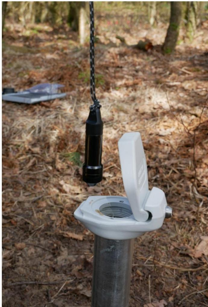
Abbildung 7 Digitaler Pegel (Diver) über den an zwei Standorten dauerhaft der Grundwasserpegel gemessen wird.
