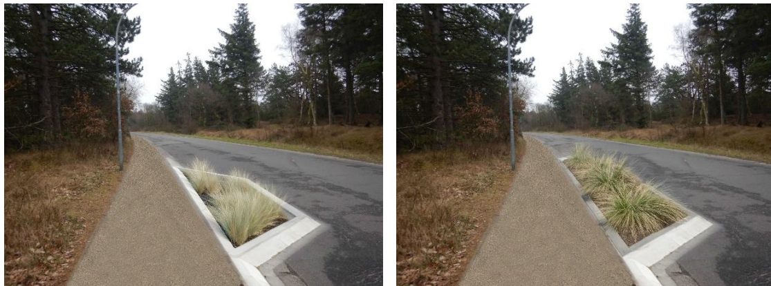
Foto 81: visualisierte Fahrbahnverengung und ungebundener Wegedecke – Beispiele der Begründungsmöglichkeiten
