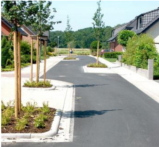
Foto 48: Verkehrsberuhigung durch versetzte Baumbeste in Kombination mit Querungsmöglichkeiten (Bildquelle: guh 2025) – nur in Wohngebieten mit sehr geringen Verkehrsaufkommen möglich
